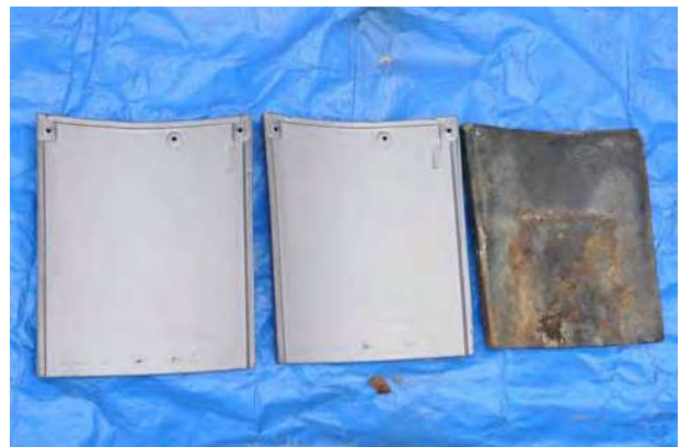
▲本瓦 平瓦 左と中央は製作物、右は原形
