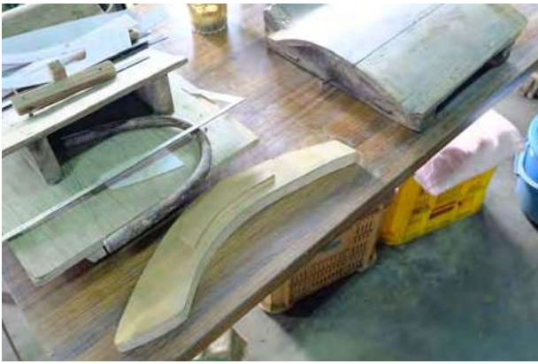
▲棧瓦 凹部の製作 凹部の木型
