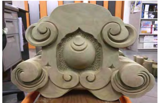
▲新たに製作の鬼瓦 1基を製作し監督職員が確認
